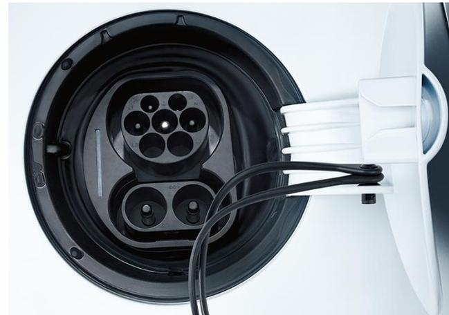
Ladeanschluss für Gleich- und Wechselspannung
