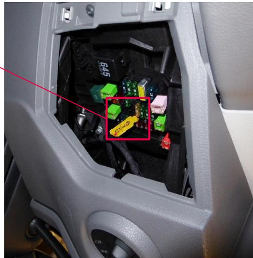
Rettungstrennstelle an einer Sicherung auf dem Sicherungsträger in der Fahrerkabine
