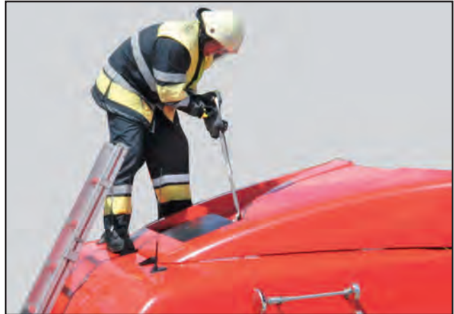
Dachklappe mit Halligan-Tool öffnen
