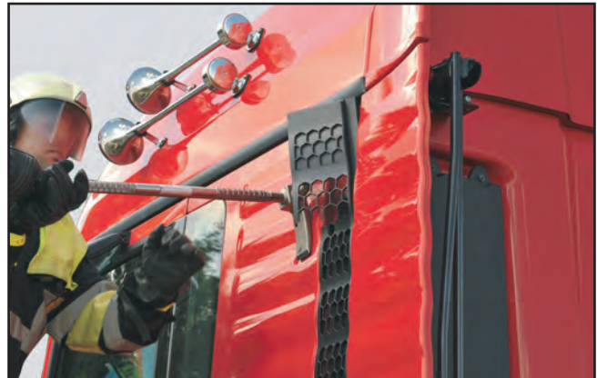
Abdeckung Luftansaugung entfernen
