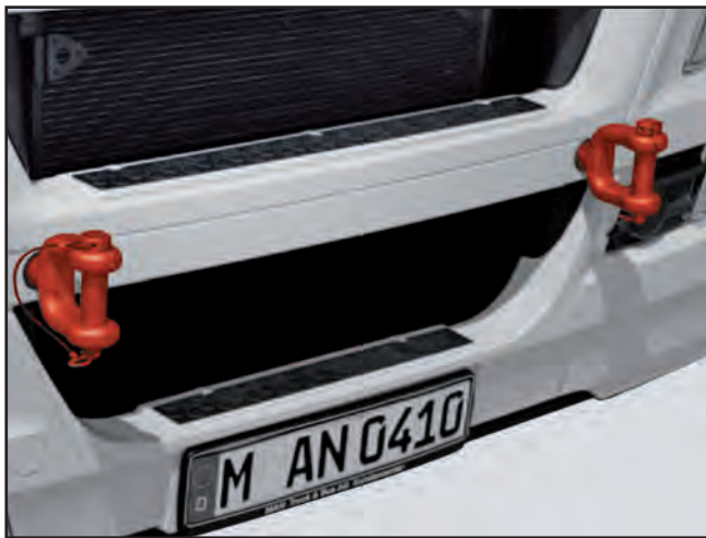
Abschleppösen vorn, beidseitig eingeschraubt
