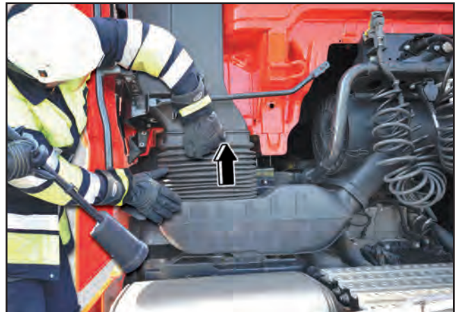
Luftansaugung links am Beispiel TGX
