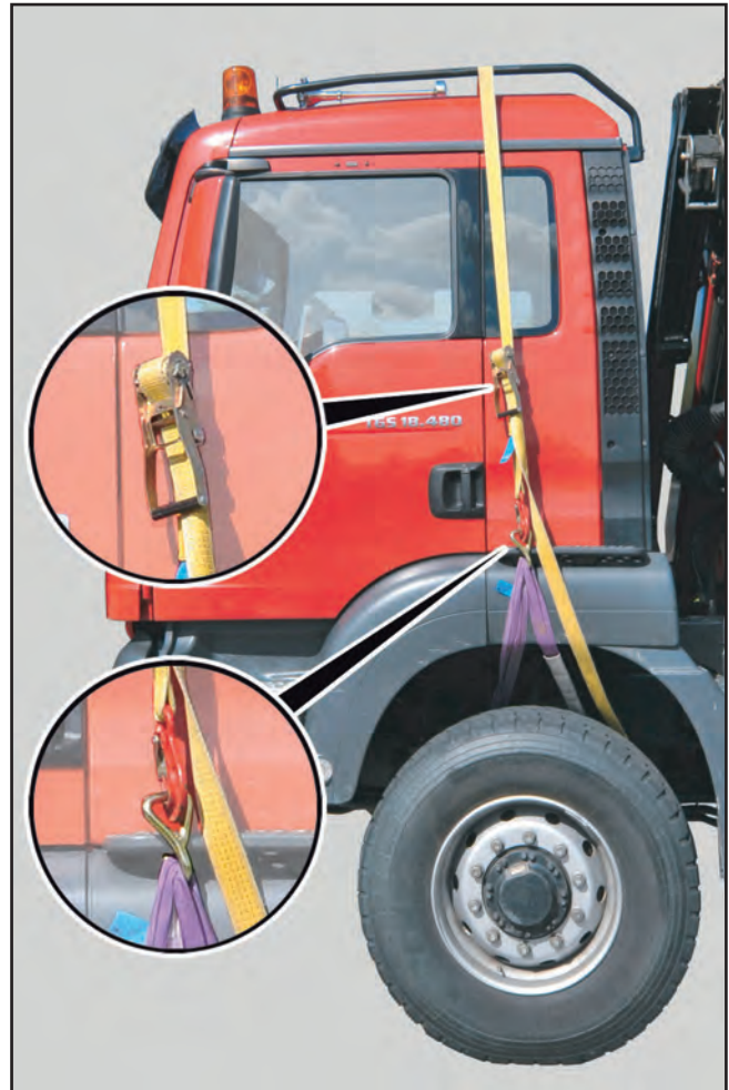
Fahrerhaus sichern am Beispiel TGS
