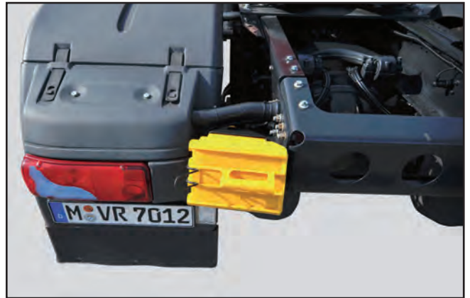
Radkeil (Beispiel TGX Sattelzugmaschine)
