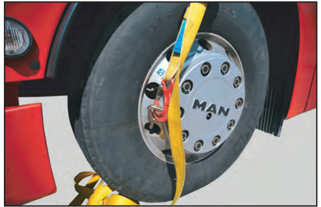
Zurrung am Rad befestigen
