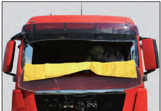
Sicherung mit Schutzdecken
