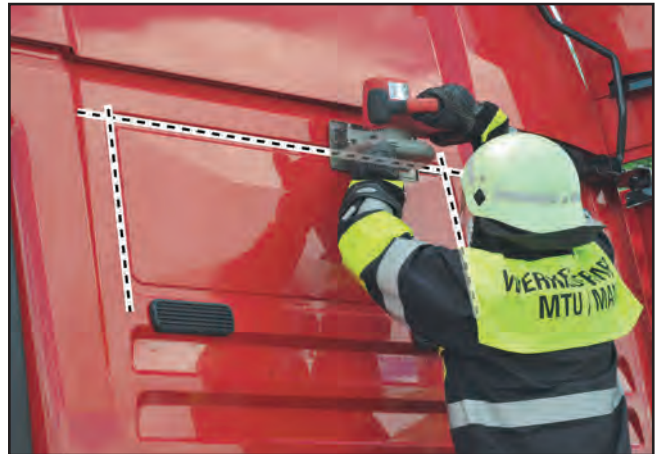
Ausschnitt in die Rückwand sägen
