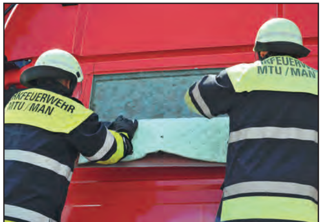
Dämmmatte nach unten klappen
