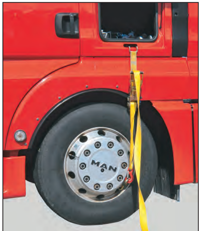
Fahrerhaus sichern über Staufachklappe am Beispiel TGX
