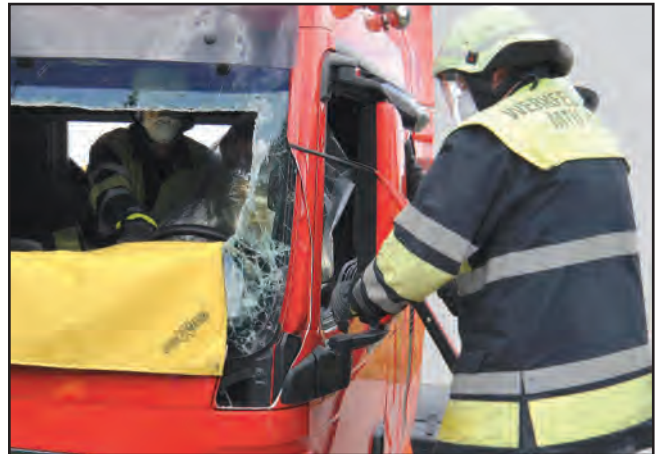
Verkleidung A-Säule entfernen
