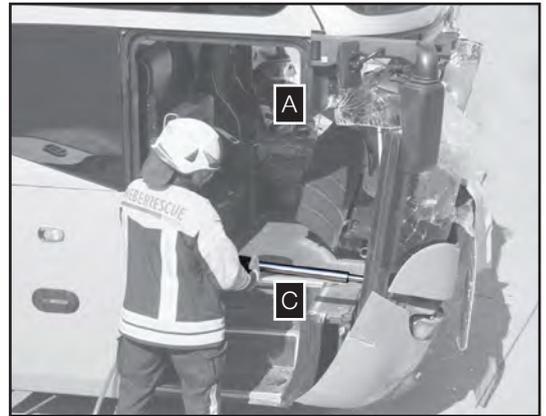
Eine weitere Möglichkeit besteht in der Mittelkonsole ebenfalls einen Rettungszyklinder einzusetzen.
